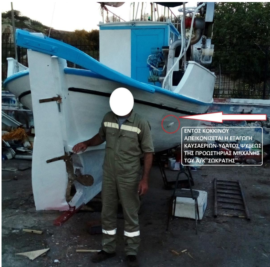
Εικόνα 5 : Απεικόνιση της εξαγωγής καυσαερίων και ύδατος ψύξεως της προωστήριας μηχανής του Α/Κ "ΣΩΚΡΑΤΗΣ"
